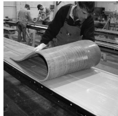
Après application de la colle sur toute la surface, placer les matrices de coffrage NOEplast contre le bord longitudinal, les dérouler sur le support de coffrage et les presser en veillant à ce qu'il n'y ait pas de poches d'air. Le cas échéant, placer des poids sur les angles et les arêtes.
