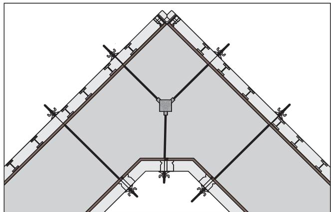
Die patenten NOE Fundamentverspannungen passen für jedes Schalsystem, z. B. von Doka, Hünnebeck, NOE, Paschal, Peri . . .
