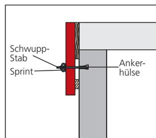
Für die Verankerung von Absturzsicherungen beim Rohbau sowie die Befestigung von Randabschalungen, Abschalkonsolen...
