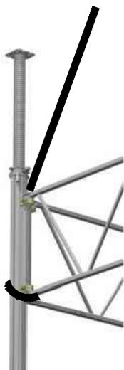
Pour dresser et transporter la tour, enrouler la suspension de levage autour des NOEprop et des deux cadres supérieurs adjacents.
