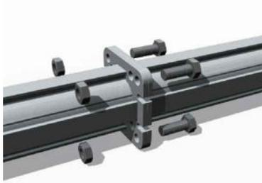
Pour procéder à une rehausse, joindre les platines articulées de 2 NOEprop et les visser avec 4 M16x40 (n° de pièce 313400).
