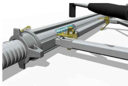
Placer le NOEclamp sur l'élément d'angle ou bien faire coulisser en position voulue le NOEclamp monté et laisser les mâchoires de serrage s'enclencher dans le profilé du tube extérieur de NOEprop.
